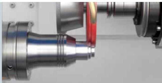
Rectificado cilíndrico exterior
