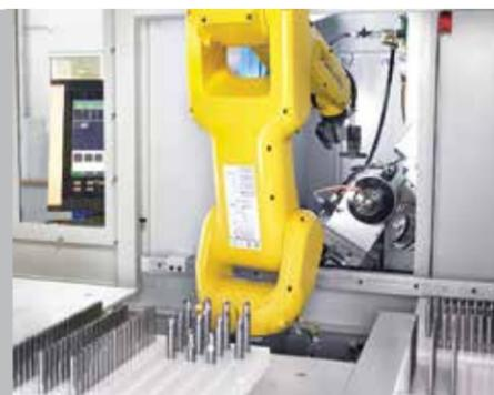
Carga con celda robotizada
