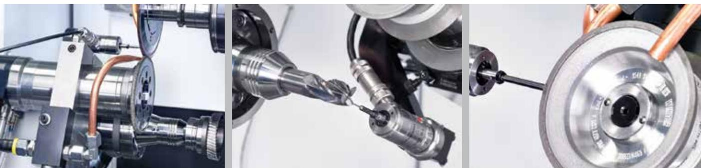
Sistema de rectificado colocado sobre el eje de la pieza (eje A)
