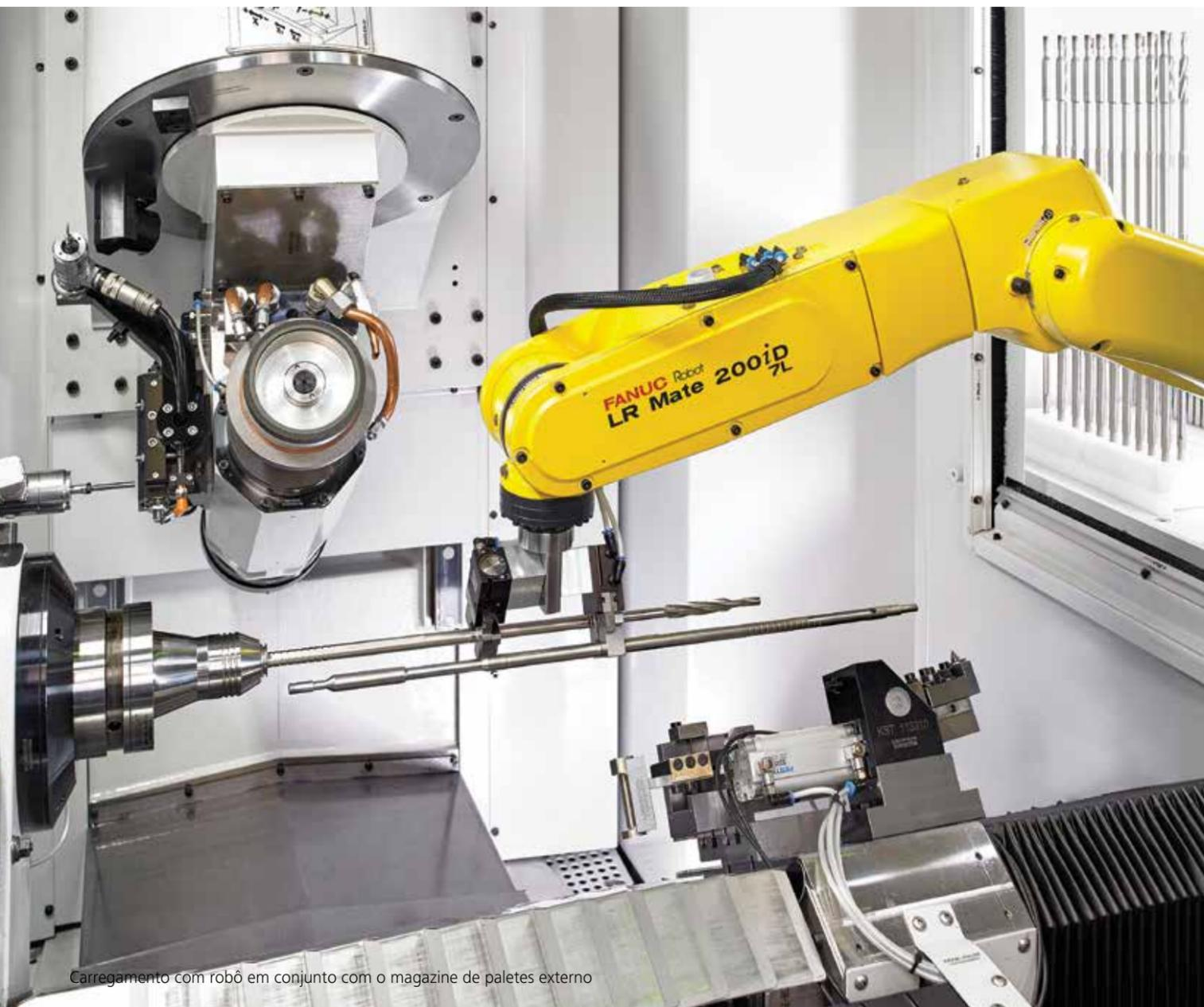
Carregamento com robô em conjunto com o magazine de paletes externo
