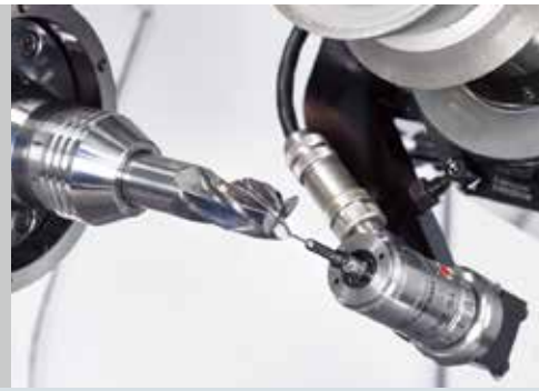
工具の位置決めと測定のための旋回式プローブ
