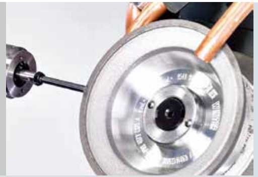
機械内で研削砥石測定を行うための追加プローブ
