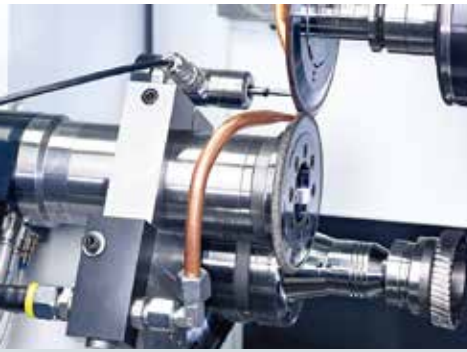
ワークピース軸 (A軸) に装備された調整機構
