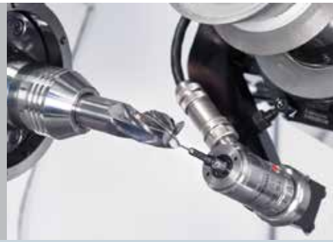
Palpeur orientable pour la détermination de la position et la mesure des pièces
