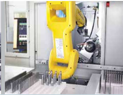
Chargement à l'aide d'une cellule de robot
