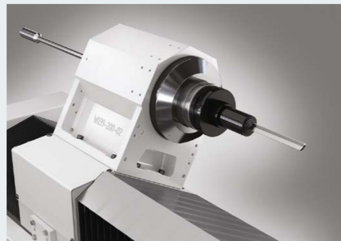
超长刀具的加工, 穿过工件轴装夹
