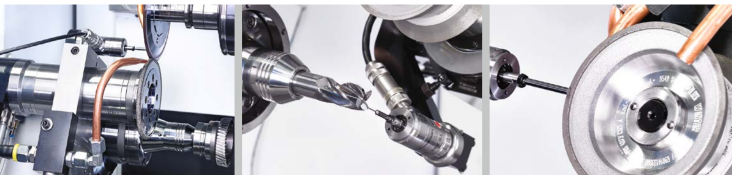
工件轴上挂有修整装置 (A 轴)
