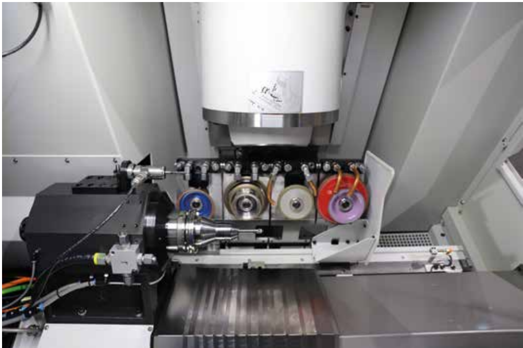
Aire de travail de la machine avec magasin de meules ouvert
