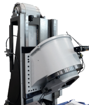
立式直线电机安装
