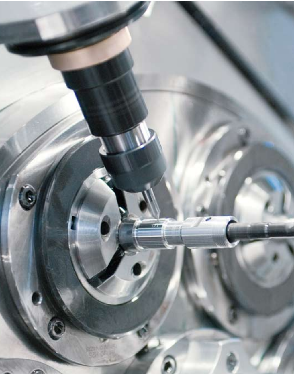
同步工作提高生产率 —— 两把刀具同时加工（车工件外圆和绞孔）
