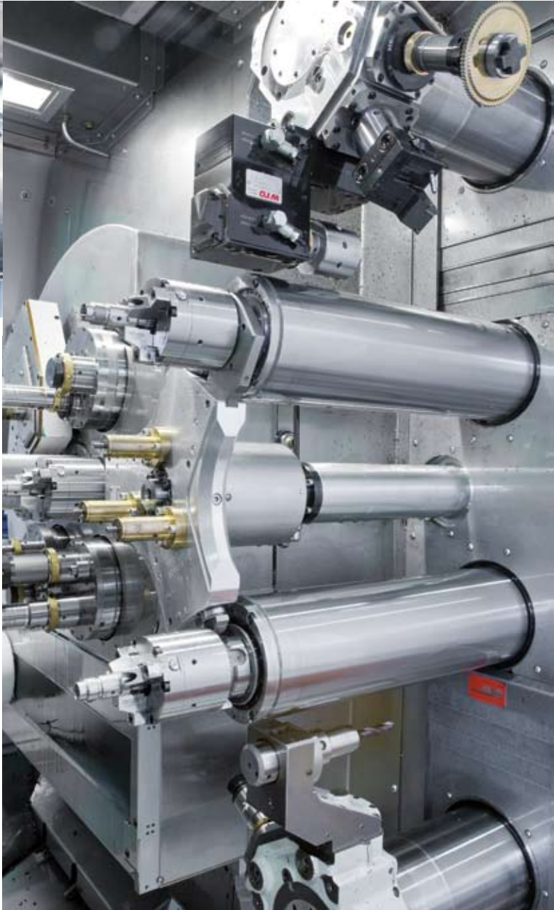
Lavorazione del secondo lato del pezzo con tre mandrini supplementari adeguati e fino a otto utensili
