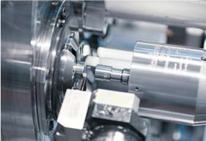
Troncatura del pezzo e trasferimento tramite il contromandrino
