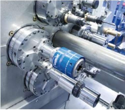
Se pueden utilizar dos herramientas por unidad de mecanizado longitudinal. Pueden usarse tanto herramientas fijas como accionadas, o incluso combinarlas. Se pueden utilizar en todas las posiciones de husillo y se pueden cambiar y añadir en cualquier momento.
