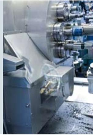
Manejo de las piezas integrado en la máquina hasta la paleta: un concepto inteligente para transportar las piezas de forma controlada y sin dañarlas. También es posible la clasificación automática de piezas de medición y mediciones en-proceso
