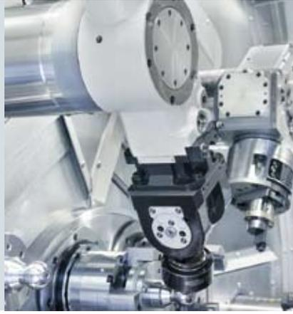
Herramienta de alisado montada en una unidad de mecanizado simple
