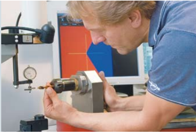
Pré-ajustagem da ferramenta fora da máquina
