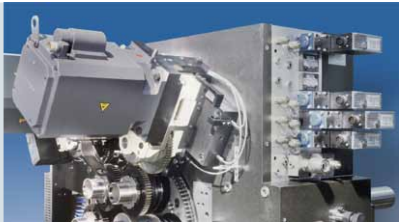
所选位置的转速可调式驱动机构
