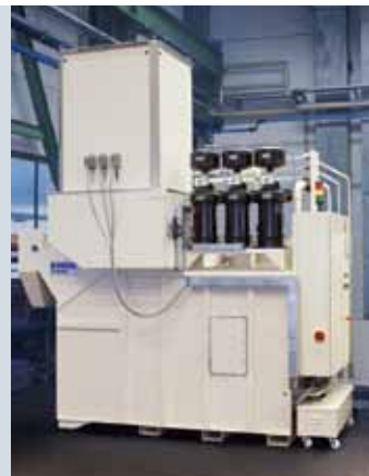
Impianto di depurazione del lubrorefrigerante con filtro del flusso intero e raffreddamento (opzionale)
