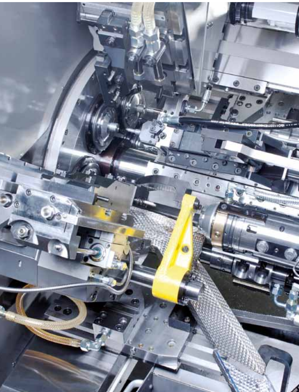
Vano di truciatura di un tornio automatico a sei mandrini della serie PC
