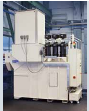
Instalación de tratamiento del lubricante refrigerador con filtro de caudal completo y refrigeración (opcional)
