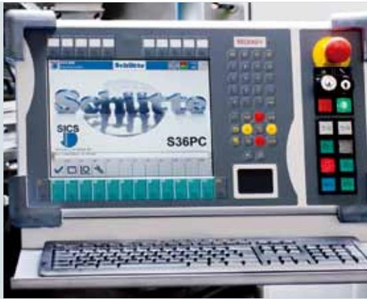
機械の両側の操作位置に旋回可能なフラットスクリーン操作盤では、操作エレメントを必要とされる位置に提供します。
