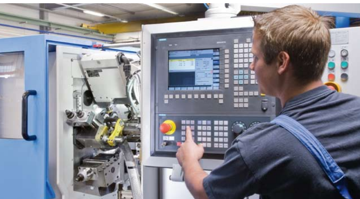
SG 18 e AG 20 – Torni automatici multimandrino con azionamento a camme ed opzioni per lavorazioni CNC
