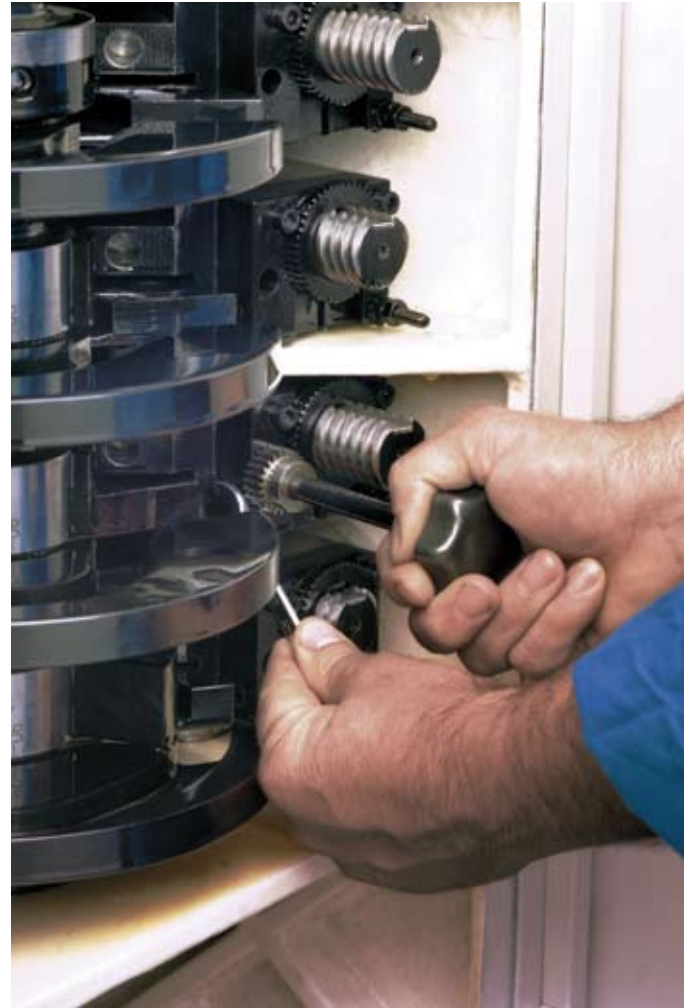
调整纵刀架连杆 — 无级调节，接触方便
