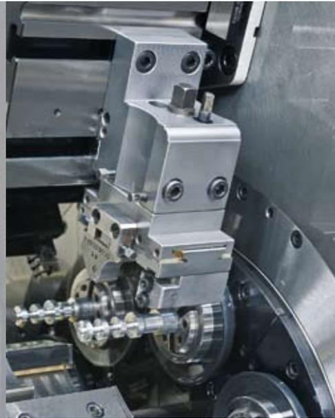
Système d'équipement modulaire complet, p. ex. pour le fraisage périphérique (en haut à gauche), le taraudage et le brochage (en haut à droite), le finissage tangentiel (au milieu à droite) et le polygone (p. 11)
