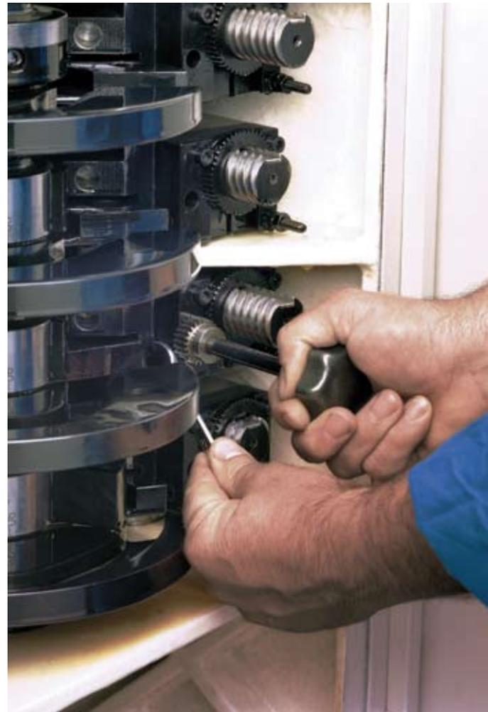
Réglage d'une coulisse de chariot longitudinal – réglable en continu et bien accessible
