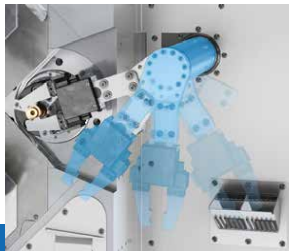
Evacuazione dei pezzi tramite manipolatore cnc
