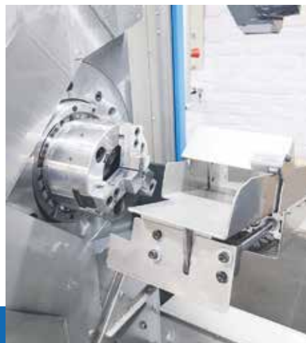
Evacuazione dei pezzi tramite scivoli
