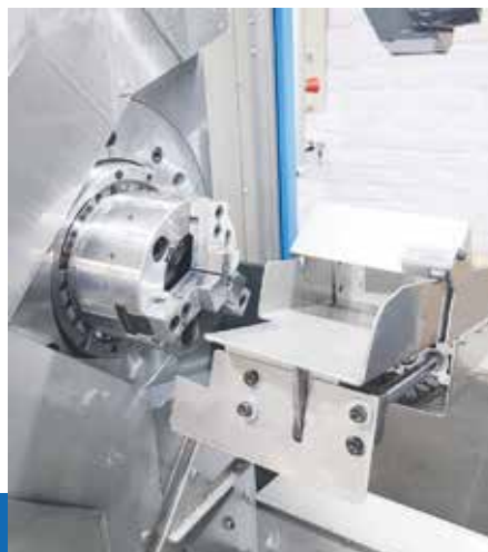
Guiado de las piezas mediante resbaladera
