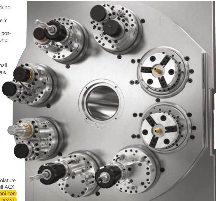
Fig. 8, Due slitte di troncatura offrono la possibilità di una lavorazione contemporanea ed estesa della parte posteriore
