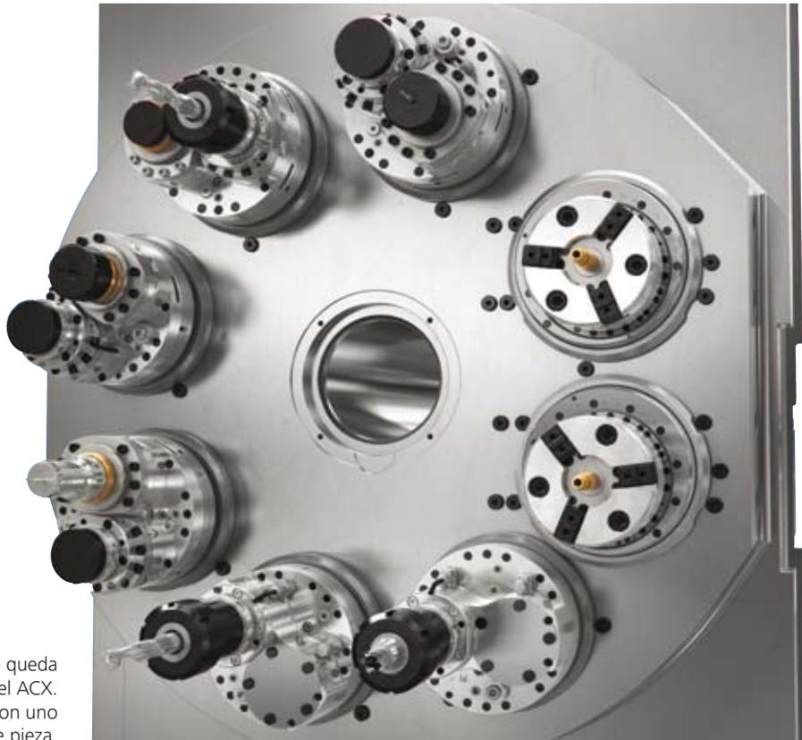
El número de pasos de arranque de viruta necesario queda determinado por el modo de funcionamiento del ACX. La gama de prestaciones incluye el mecanizado con uno o dos husillos del segundo lado de pieza.
