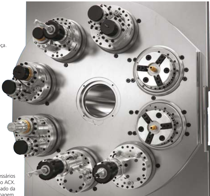
Fig. 4, O ACX é também flexível na remoção de peças. Aqui estão disponíveis vários sistemas de transferência longitudinal e transversais. A remoção sem danos e orientada das peças também está prevista no conceito do ACX.
