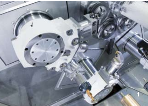
Fig. 1, Sequência de imagens, da esquerda para a direita: Livre configuração dos cabeçotes de ferramentas em todas as posições de fuso.
