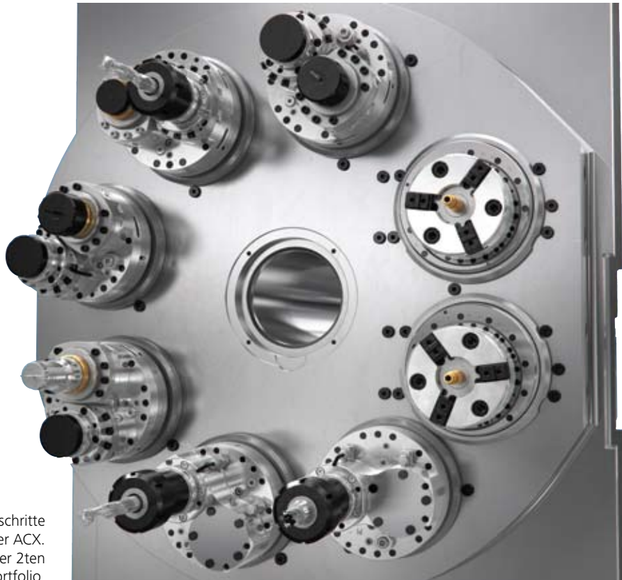
Abb. 3, Mit der programmierbaren Mehrkant-Dreheinrichtung lassen sich leicht vielfältige Flächen an einem Werkstück erzeugen.
