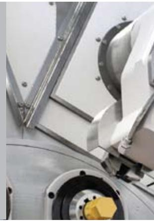
Abb. 3, Mit der programmierbaren Mehrkant-Dreheinrichtung lassen sich leicht vielfältige Flächen an einem Werkstück erzeugen.
